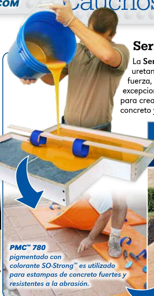
**PMC™ 780** pigmentado con colorante SO-Strong™ es utilizado para estampas de concreto fuertes y resistentes a la abrasión.
