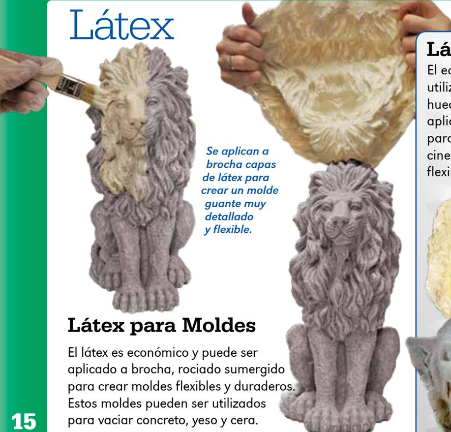
*Se aplican a brocha capas de látex para crear un molde guante muy detallado y flexible.*
