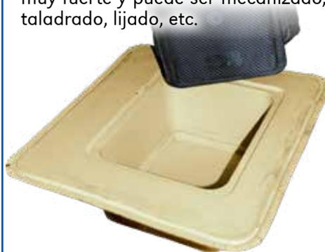
Herramienta de SmoothCast™ 380 utilizada para fabricar carcasas negras para electrónicos.
